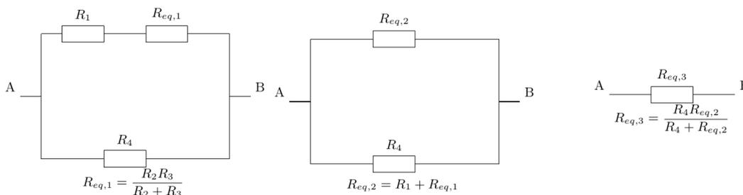
Finalemment  $R_{eq,3} = \frac{R_1 R_2 R_4 + R_1 R_3 R_4 + R_2 R_3 R_4}{R_1 R_2 + R_1 R_3 + R_2 R_4 + R_3 R_4 + R_2 R_3}$
