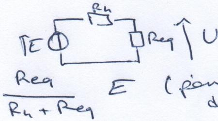
$$U = \frac{R_{eq}}{R_4 + R_{eq}} E \quad (\text{point diviseur de tension})$$
