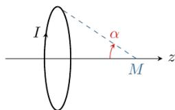
Le champ créé par une spire circulaire de rayon  $R$  parcourue par un courant d'intensité  $I$  peut se calculer analytiquement. En un point  $M$  de cote  $z$  appartenant à l'axe de la spire, il prend la forme particulièrement simple :
