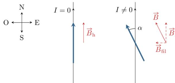
FIGURE 2 – Schéma de principe de l'expérience. Le sens de  $B_{fil}$  est obtenu à partir de la règle de la main droite, en raisonnant en vue de dessus avec l'aiguille aimantée placée en dessous du fil.
