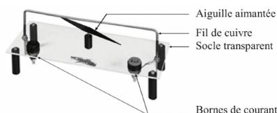
Figure 2 – Dispositif d'Ørsted.
