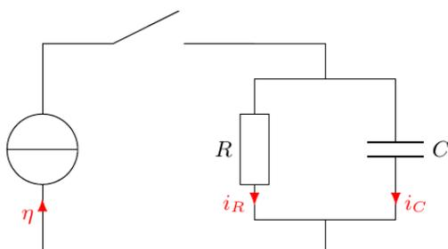
On étudie la charge  $q(t)$  du condensateur dans le circuit ci-contre. La source de courant est idéale, de courant électromoteur  $\eta$ . Le condensateur idéal, de capacité  $C$  étant non chargé, on ferme l'interrupteur à l'instant  $t = 0$ .
