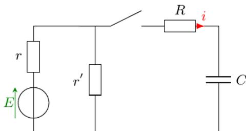
Le générateur est un générateur de tension  $E$  continue. À  $t = 0$ , on ferme l'interrupteur. Le condensateur est initialement déchargé.
