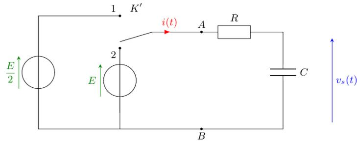
A la date  $t = 0$ , le condensateur étant déchargé, on ferme l'interrupteur  $K'$  dans la position 1 (phase 1). Lorsque la charge sous la tension  $E/2$  est terminée, on bascule  $K'$  dans la position 2 (phase 2) et on procède à la charge du condensateur sous la tension  $E$ .
