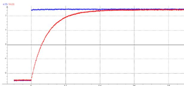
Tension  $u_C(t)$  aux bornes d'un condensateur.
