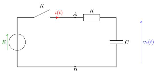
Un dipôle comporte entre deux bornes A et B une résistance  $R$  et un condensateur de capacité  $C$  placés en série. On place aux bornes A,B un générateur de f.é.m constante  $E$  et un interrupteur  $K$ . Initialement le circuit est ouvert et le condensateur déchargé. Soit  $v_s$  la tension aux bornes du condensateur. À l'instant  $t = 0$ , on ferme l'interrupteur  $K$ .
