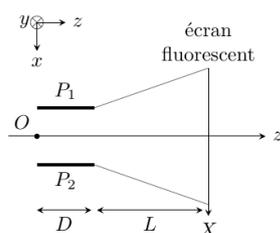
Une zone de champ électrique uniforme est établie entre deux plaques  $P_1$  et  $P_2$ , le champ est supposé nul en dehors de cette zone et les effets de bord sont négligés. La distance entre les plaques est notée  $d$ , la longueur des plaques  $D$  et on note  $U$  la tension (supposée constante et positive) entre les plaques, égale à la tension d'entrée de l'oscilloscope. On admet que le champ électrique entre les plaques s'écrit :
