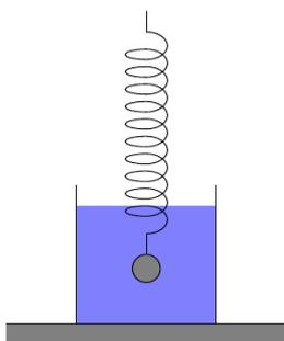
Un sphère de rayon  $r$  et de masse  $m$  est suspendue à un ressort de raideur  $k$  et de longueur à vide  $l_0$ . Déplacée dans un liquide de coefficient de viscosité  $\eta$ , la sphère est soumise à une force de frottement donnée par la formule de Stokes :
