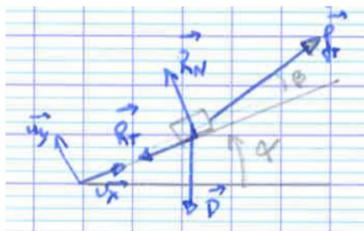
1.a Système traîneau (supposé ponctuel), référentiel terrestre supposé galiléen, bilan des forces : poids, tension du fil, réaction du sol. Le PFD projeté suivant  $\vec{u}_x$  et  $\vec{u}_y$  s'écrit
