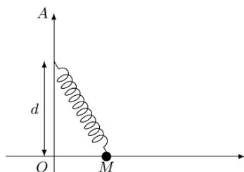
Un point matériel  $M$  de masse  $m$  se déplace sans frottements le long d'un axe horizontal  $Ox$  (perle enfilée sur  $Ox$ ). Il est lié par l'intermédiaire d'un ressort sans masse de longueur à vide  $l_0$  et de raideur  $k$ , à un point situé à la verticale de  $O$  tel que  $OA = d$ . On note  $l = AM$  la longueur du ressort à un instant  $t$ . On néglige les frottements.
