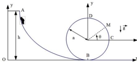
Une voiture de manège de masse  $m = 24 \text{ kg}$  est assimilée à un point matériel. Cette voiture est posée sur deux rails parallèles et glisse sans frottement selon la trajectoire constituée en partie d'un cercle de rayon  $a = 4,7 \text{ m}$  de la figure ci-dessous. La voiture est abandonnée sans vitesse au point A d'altitude  $h > a$ .
