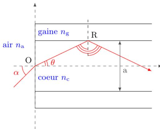
Une fibre a saut d'indice est formée d'un cœur cylindrique d'axe  $OX$  et de diamètre  $a$ , homogène et isotrope d'indice de réfraction  $n_c$  ; entourée d'une gaine homogène et isotrope d'indice de réfraction  $n_g$  , légèrement inférieur à  $n_c$  . La fibre est limitée à ses extrémités par deux plans perpendiculaires à  $OX$  . L'indice de l'air est noté  $n_a$  inférieur à  $n_c$  et  $n_g$  . On étudie la propagation d'un rayonnement monochromatique dans le plan  $XOY$  .
