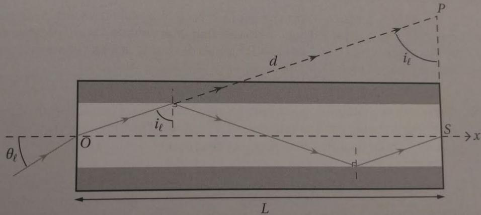
**Figure 2.19.** Dépliement du trajet effectué par la lumière dans la fibre pour le calcul de  $T_2$ .
