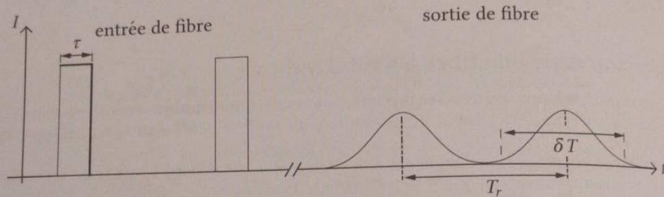
Figure 2.20. Intensité lumineuse en sortie de fibre optique.
