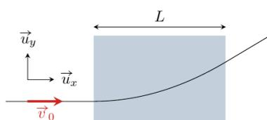
Un électron de masse  $m$ , d'énergie cinétique  $E_{c0} = 80 \text{ keV}$  pénètre à vitesse  $\vec{v}_0$  horizontale dans une cavité de longueur  $L = 1 \text{ m}$  où règne un champ électrique uniforme de norme  $E_0$  constante.
