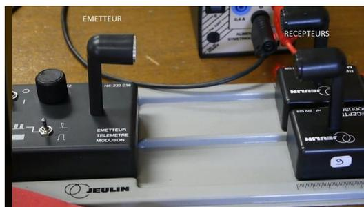
FIGURE 1 – Schéma du montage expérimental étudier les ultrasons.
